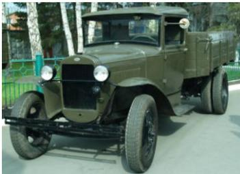
**ГАЗ-АА (полторка)** — грузовой автомобиль Нижегородского (в 1932 году), позже Горьковского автозавода, грузоподъёмностью 1,5 т, известный как полторка.
