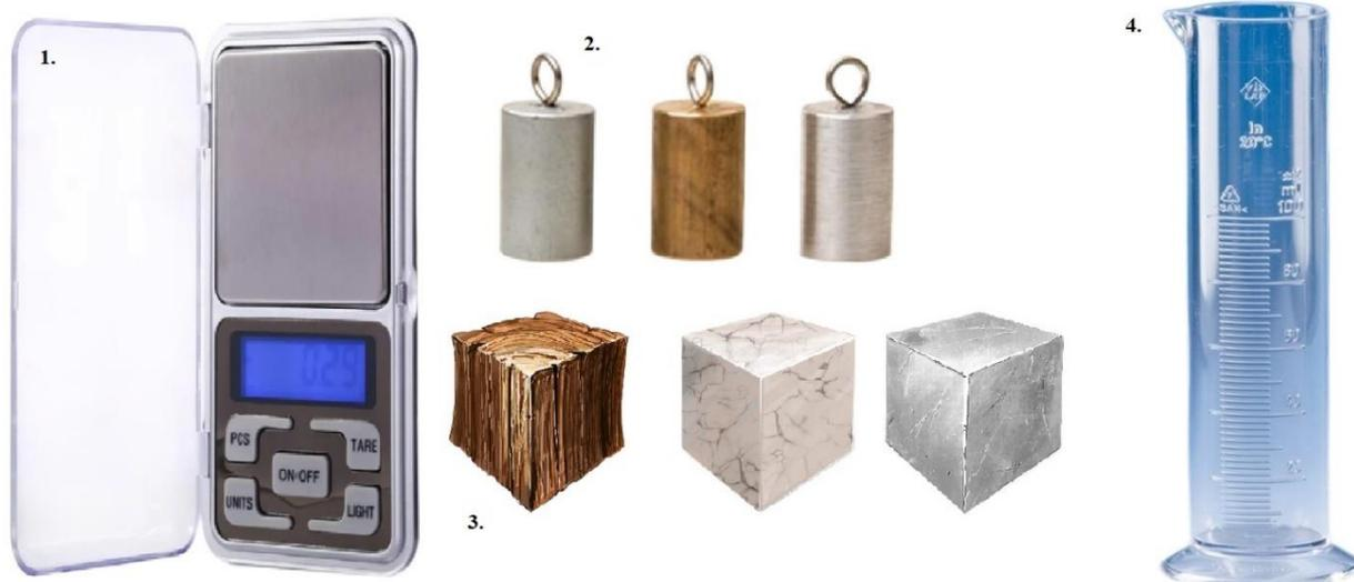
Рисунок 1 – лабораторное оборудование, где 1 – электронные весы, 2 – металлические цилиндры, 3 – кубики из разных материалов, 4 – измерительный цилиндр.
