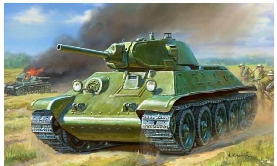
Благодаря широким гусеницам и мощному дизельному двигателю отличался подвижностью и маневренностью, уникальным сочетанием толщины брони, формы корпуса и понятной компоновкой механизмов. Орудие танка демонстрировало хорошую прицельность и дальность. Это самый лучший средний танк Второй мировой войны.
