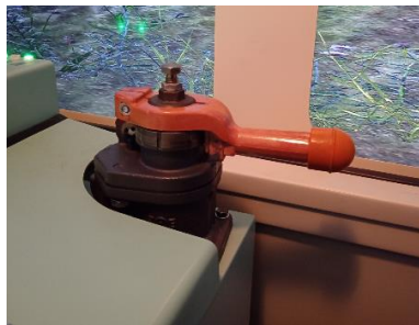
Крайнее тормозное положение крана машиниста №254
