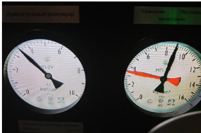
ТМ разряжена на на 0,15 - 0,17 МПа
