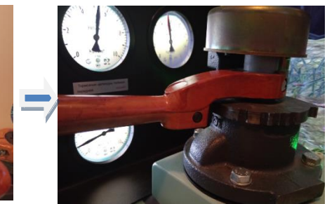
Ручка крана машиниста № 394 1-е положение- отпуск тормозов установленным порядком
