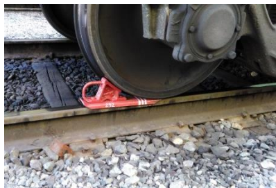
При необходимости производится закрепление состава
