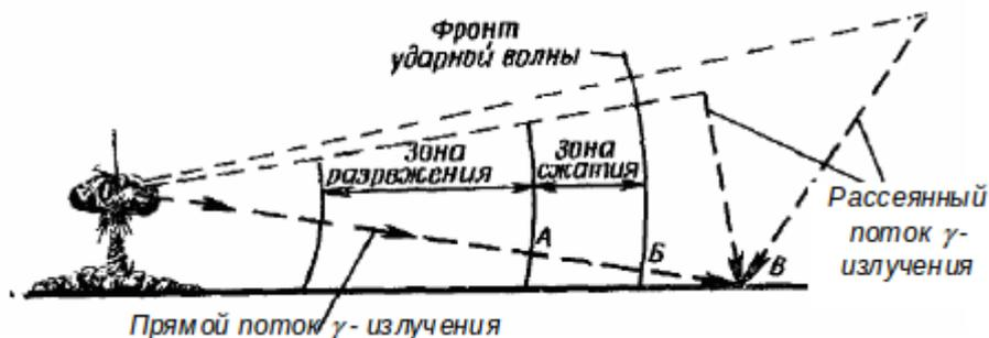
Рисунок 19 - Схема распространения гамма-излучения ядерного взрыва
