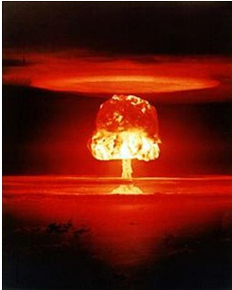
Рисунок 28 - Испытание термоядерной бомбы на атолле Бикини, 1954 г. Мощность взрыва 11 Мт, из которых 7 Мт выделилось от деления тампера из урана-238
