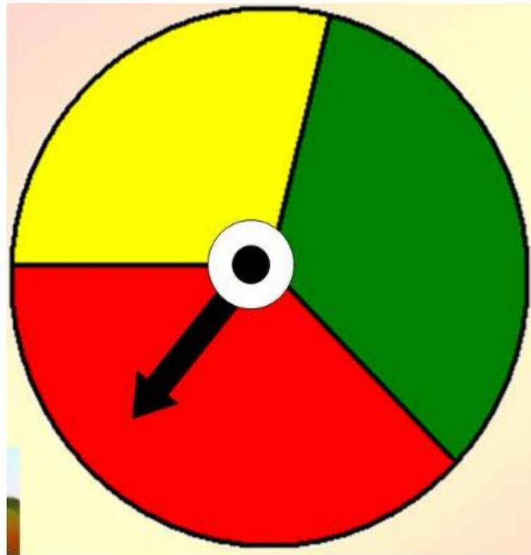
Конструкция этого светофора была выполнена в виде циферблата часов, разделенного на секторы зеленого, желтого и красного цветов. Переключение между цветами осуществлялось с помощью стрелки (как у часов)
