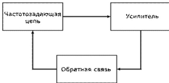
Рис.10. Функциональная схема генератора.
