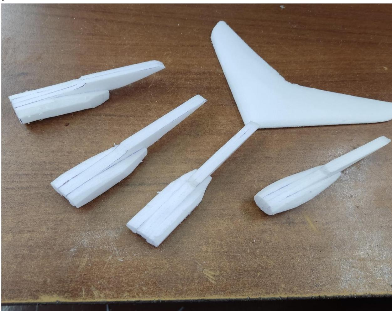
Склеиваем все детали и окончательно окрашиваем модель
