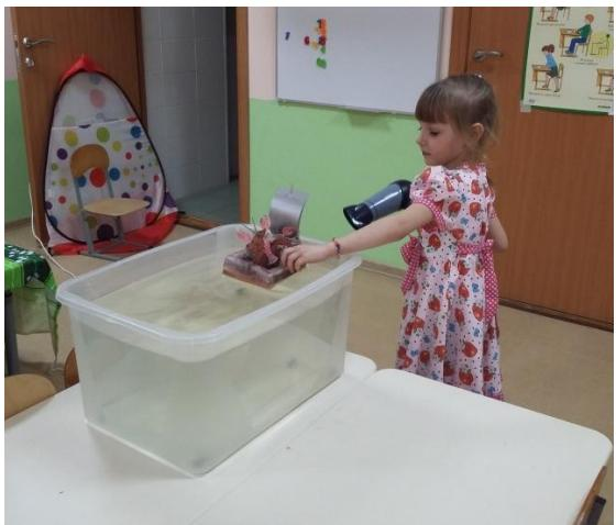
Многие даже не догадываются, что парус это крыло, и принцип работы крыла и паруса один. В его основе лежит подъемная сила, только если подъемная сила крыла летательного аппарата, используя встречный ветер, толкает самолет вверх, то вертикально расположенный парус направляет парусник вперед. Чтобы объяснить это с научной точки зрения необходимо вернуться к истокам - как работает парус.
