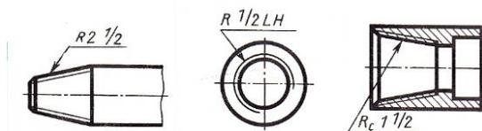
Рисунок 3 – Обозначение резьбы трубной конической
