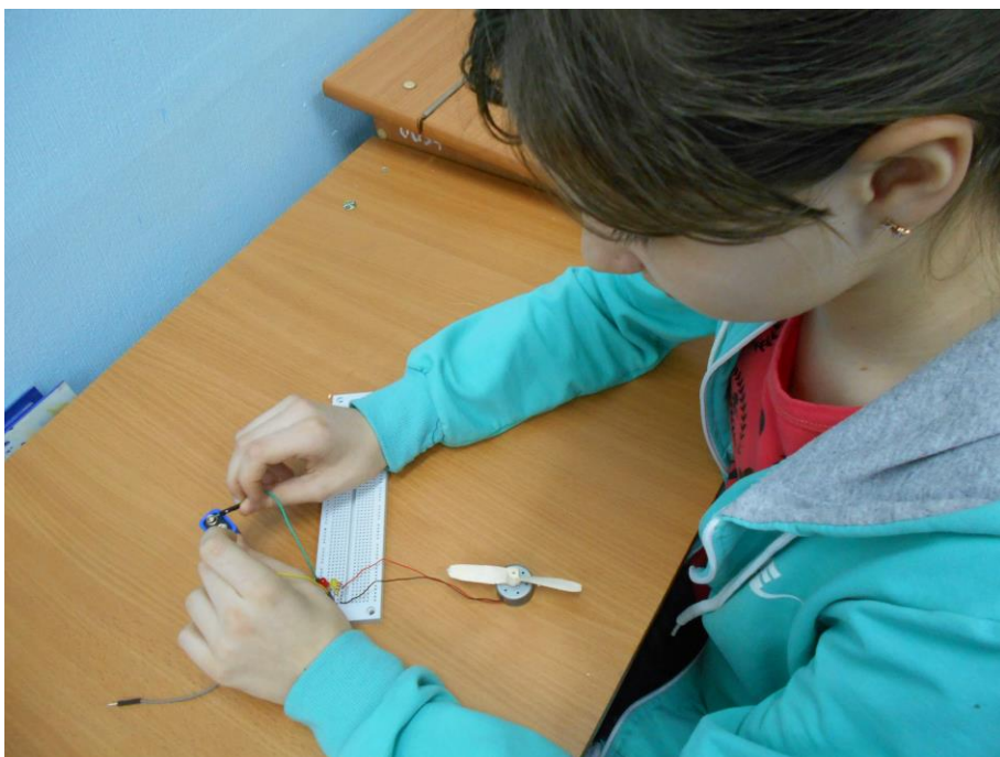
сборка схемы питания электродвигателя на макетной плате
