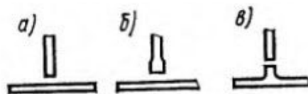
Рисунок 4.14-Варианты соединения стенки балки с полкой
