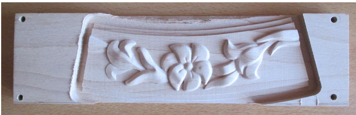
Рис. 10. Заготовка-болванка после всех обработок на ЧПУ-станке (материал – дерево бук)
