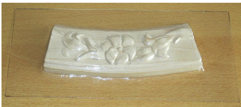
Рис. 12. Заготовка-болванка, обтянутая плёнкой ПЭТ
